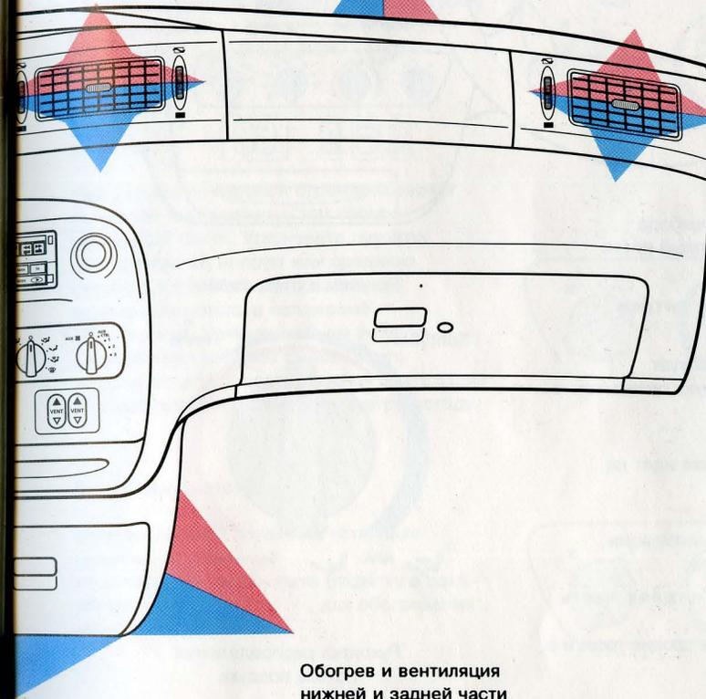
Обогрев и вентиляция нижней и задней части салона
